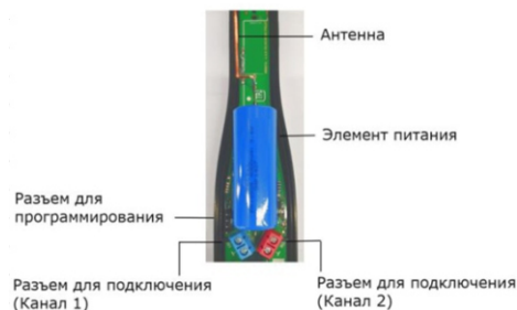
Рисунок 1 - Обозначения основных элементов радиомодема
